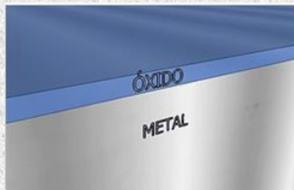
Concepção artística do corte de uma barreira de óxido vista ao microscópio.
